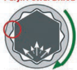
CONTACTO REDONDEADO Excelente transmisión de torsión
